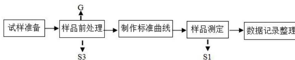
图 4 食品中重金属砷实验检验流程及产污节点图
